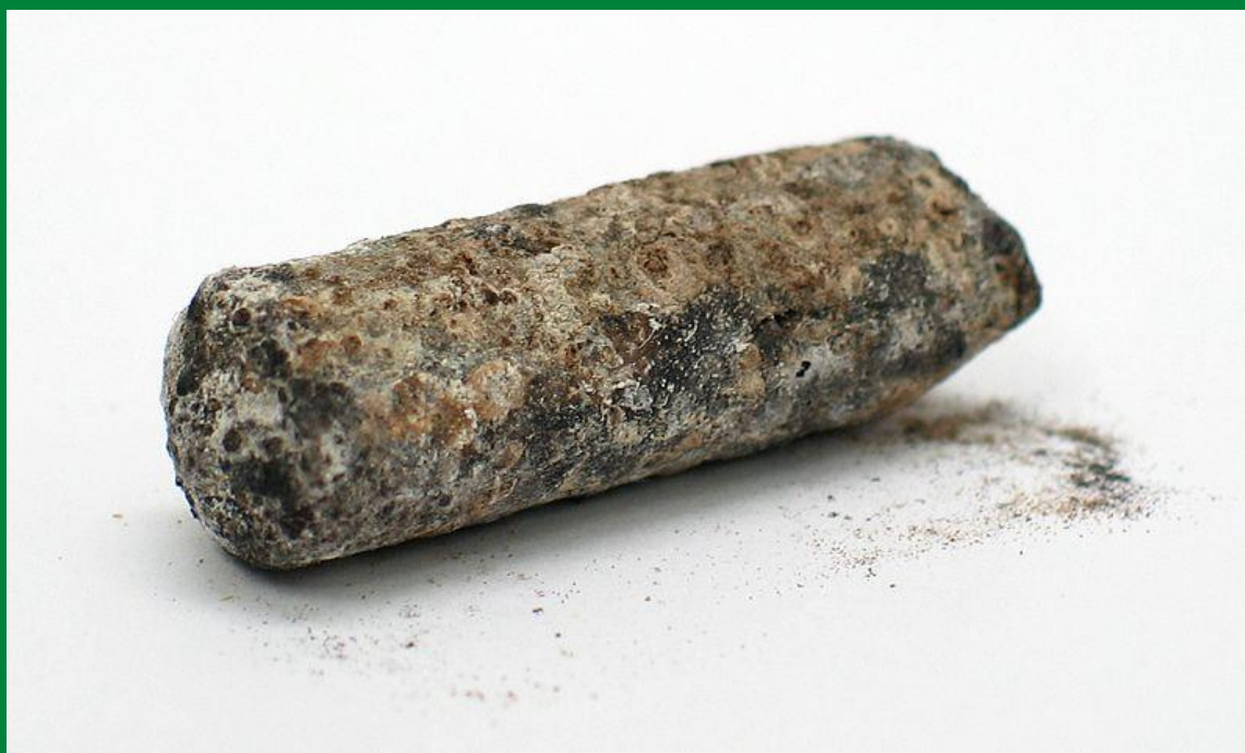
Таллий, покрытый продуктами коррозии
