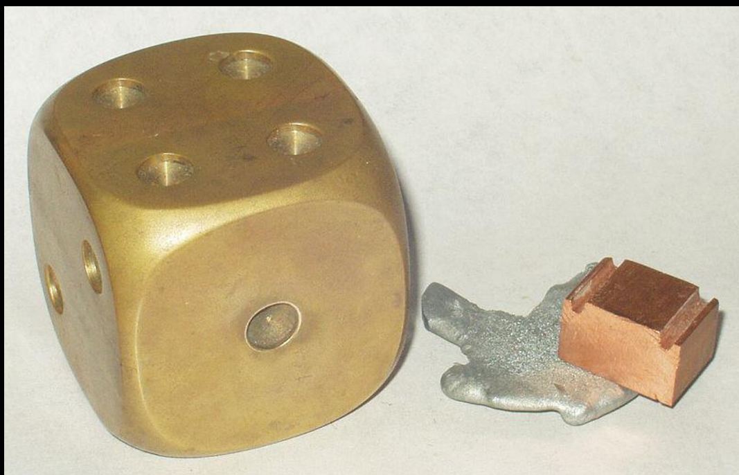
Латунь (слева) и металлы, входящие в ее состав - цинк и медь (справа)
