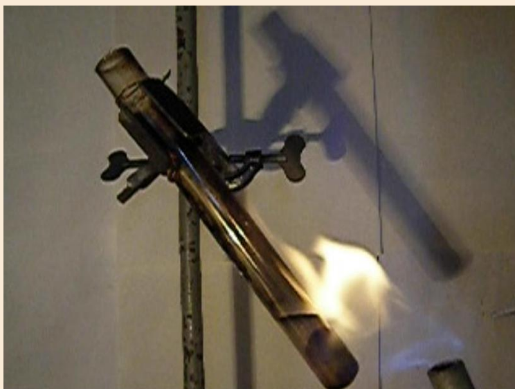
Реакция магния и диоксида кремния (получение силицида магния)
