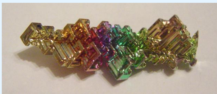
Кристаллы висмута, покрытые тонкой оксидной пленкой (видна интерференция света).
