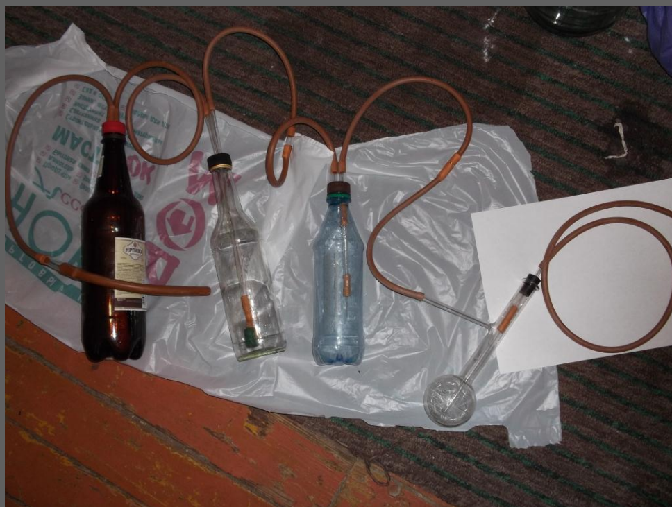
Установка для получения закиси азота (веселящего газа) [колба с селитрой не подсоединена, маленькая колба Вюрца (справа) играет роль ловушки]
