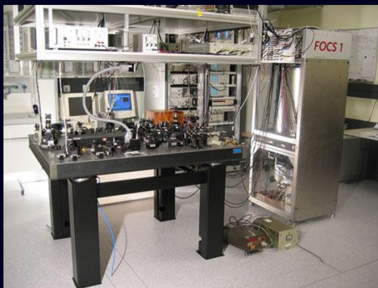
Цезиевые атомные часы (неточность - одна секунда в 30 миллионов лет)
