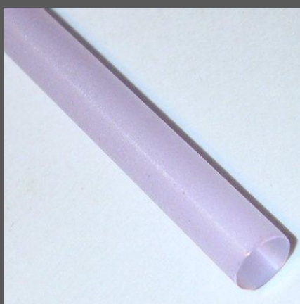
Стержень из алюмо-итриевого граната Y_3Al_5O_{12} (YAG) с добавками неодима (Nd) - рабочее тело лазера
