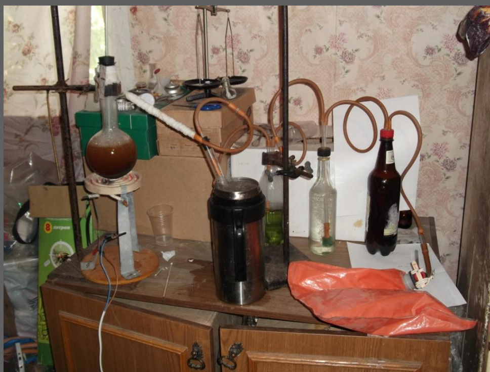
Установка для получения закиси азота (веселящего газа)
