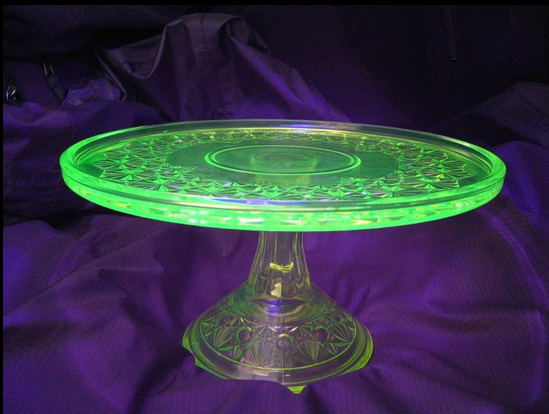
Стекло с добавками соединений урана флюоресцирует под действием УФ-облучения
