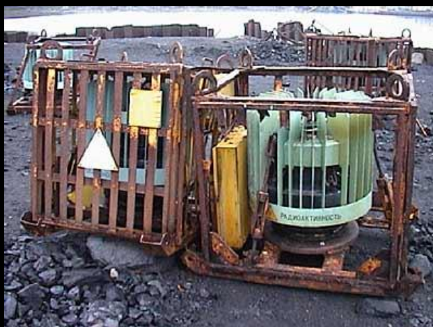
Разрушенный советский радиоизотопный генератор, который работал на ^{90}\text{Sr}
