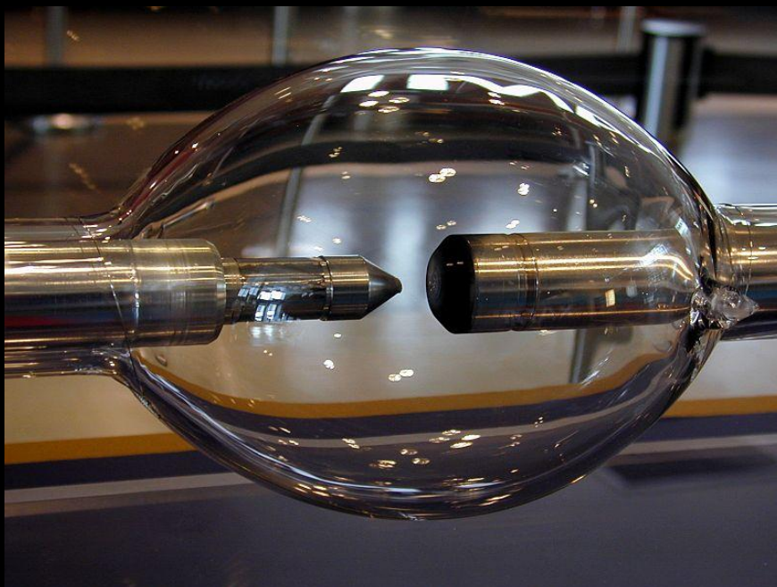
Ксеноновая дуговая лампа (мощность 15 кВт)
