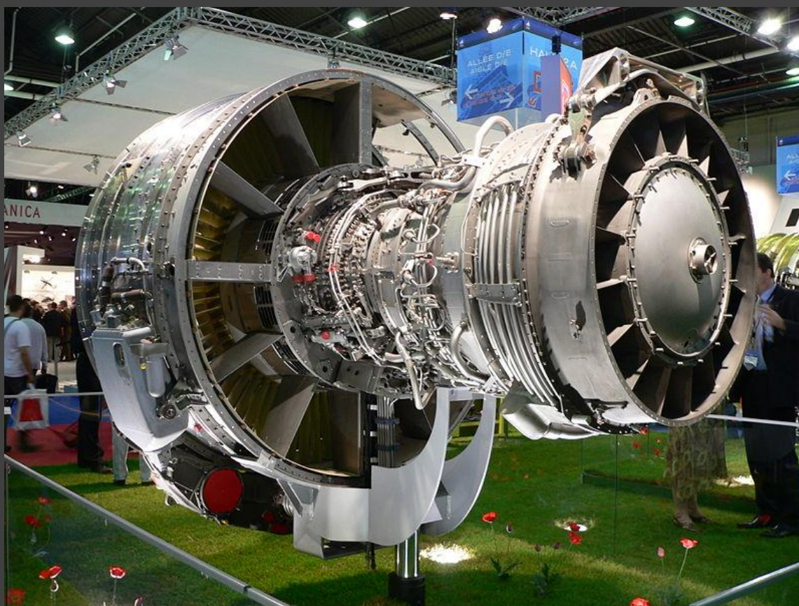
Лопasti этого авиадвигателя содержат 3% рения.
