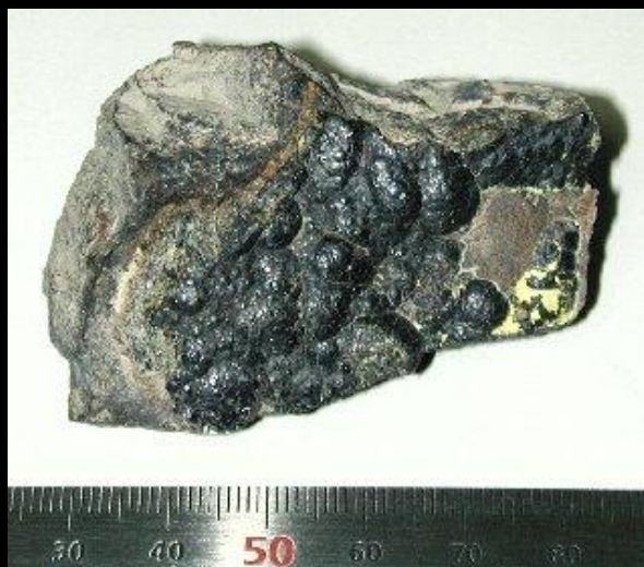
Этот образец минерала настуран (уранинит, урановая смолка, урановая смоляная обманка) содержит примерно 100000 атомов ( 3.3 \cdot 10^{-20} г) франция-223
