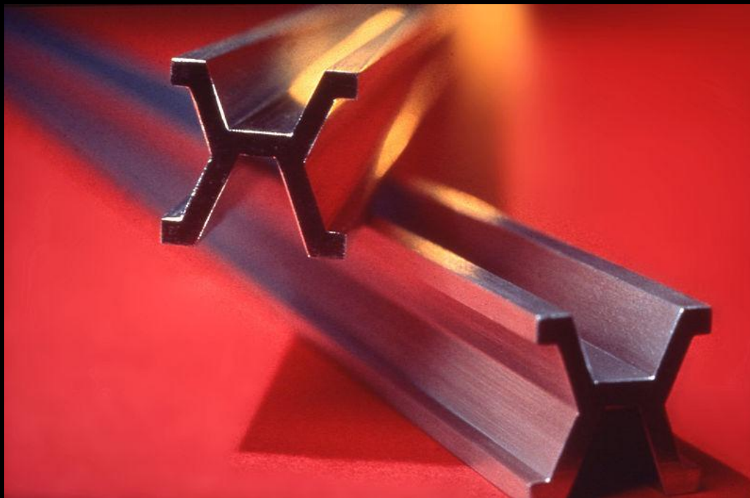
Сплав, состоящий из 90% платины и 10% иридия, использовался с 1889 по 1960 гг. в качестве эталона длины.
