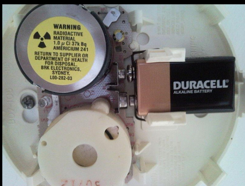
Внутреннее устройство детектора дыма на основе америция
