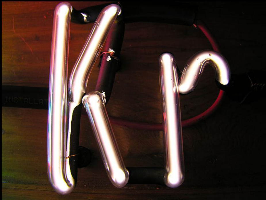
Разряд в трубке с криптоном
