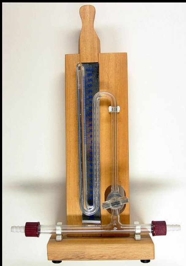
Ртутный манометр, используемый для измерения давления ниже атмосферного
